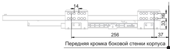
Размеры дна и задней стенки /
