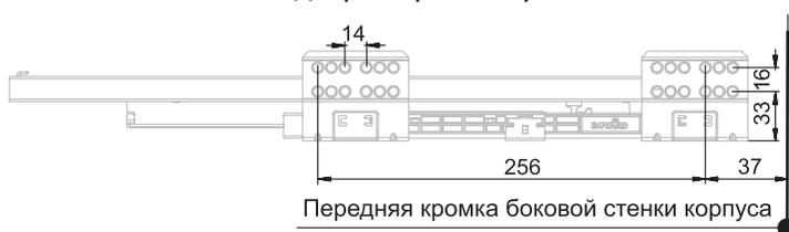
Размеры дна и задней стенки /
